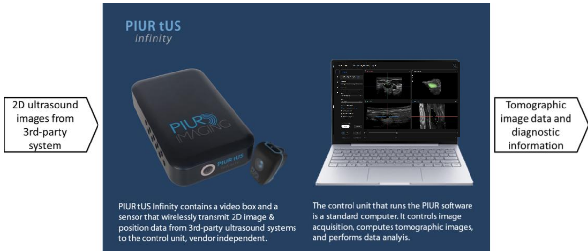
Figure 1: Configuration du système PIUR tUS Infinity
