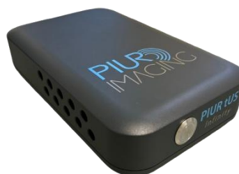
Infinity Box REF 1000 (entrée HDMI pour câble vidéo pour connexion avec l'appareil ultrasonore)
