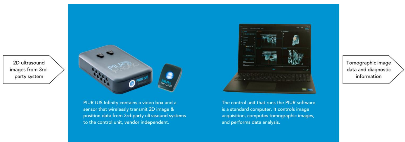
Figure 1: Configuration du système PIUR tUS Infinity
