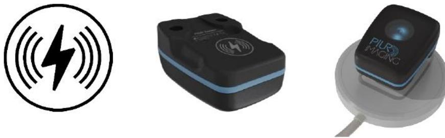
Abbildung 16: PIUR Sensor auf der Ladestation
